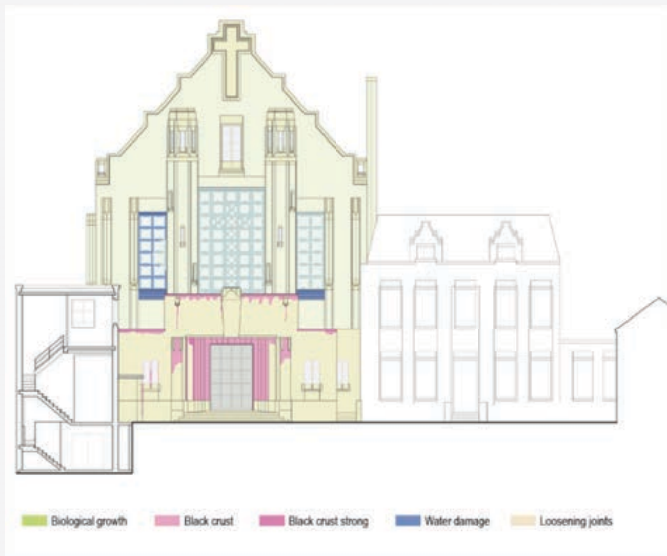
Schade aan de zuidgevel.
