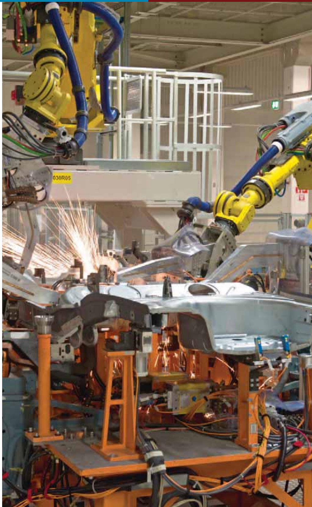
Robotisation à l'usine de montage automobile Audi Brussels à Forest. Robots aan het werk bij autobouwer Audi Brussels in Vorst. Robots at work in the Audi Brussels car assembly factory in Forest.
