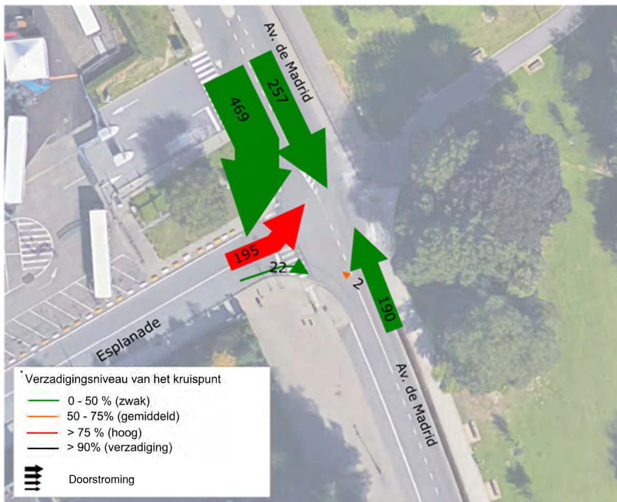
Afbeelding 164: Belang van stromen en verzadigingsgehalte van het kruispunt Madridlaan - Esplanade tijdens ochtendspits (ARIES, 2016)
