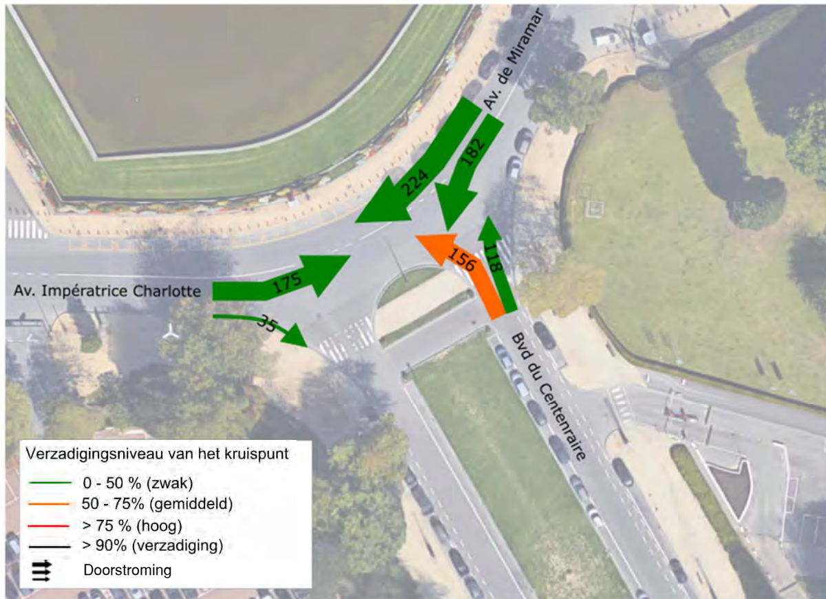
Afbeelding 168: Belang van de stromen en het verzadigingsgehalte van het kruispunt tussen de Keizerin Charlottelaan - Miramarlaan - Eeuwfeestlaan tijdens avondspits (ARIES, 2016)
