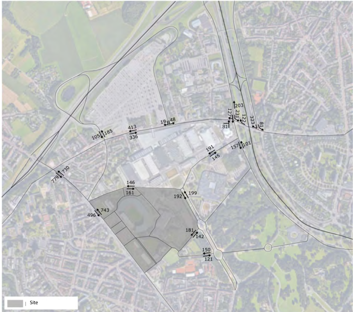
Afbeelding 171: Doorstroming (vrtg/uur) tijdens de zaterdagspits (ARIES, 2016)
